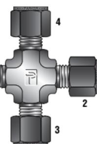
**Gerade Verbinde und Winkel:** Der größere CPI™ Anschluss wird zuerst genannt, dann der kleinere CPI™ Anschluss oder die Gewindegroße.
