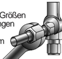
2. Anschließend wird mit einer Prüflehre für die entsprechende Verschraubungsgröße geprüft, ob diese in den Spalt zwischen Körper-Sechskant und Überwurfmutter passt. Wenn die Prüflehre NICHT IN DEN SPALT PASST, wurde die Mutter korrekt angezogen. Sollte die Prüflehre jedoch in den Spalt, muss die Montage der Verschraubung wiederholt werden.
